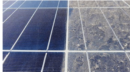
Toz ve kir enerji üretimini olumsuz etkiler
