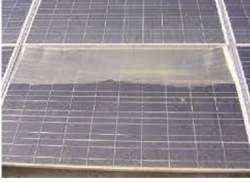
Delaminasyon Hatası Olan Bir Panel
