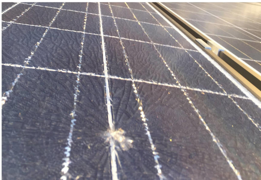
Cam kırıkları, güneş panellerinin ekonomik ömürlerinin sonunu getirir.
