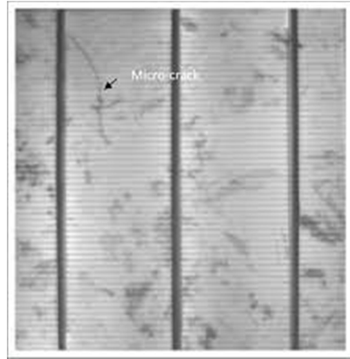
Mikro Çatlak Görüntüsü
